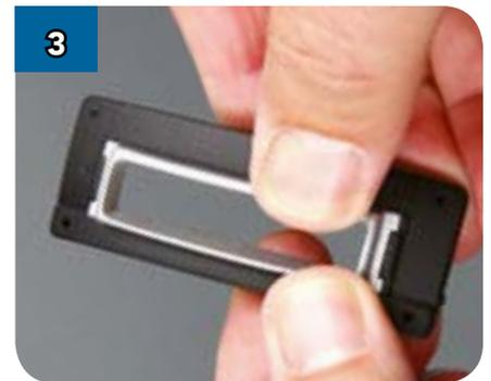
Аккуратно соедините две рамки. При этом защёлки на каждом конце детали (DF-46) должны войти в соответствующие гнезда детали (DF-47).
