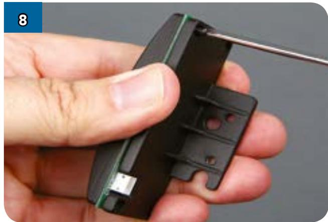
Вставьте крепёжный винт в одно из угловых отверстий в детали (DF-49) и аккуратно затяните его.
